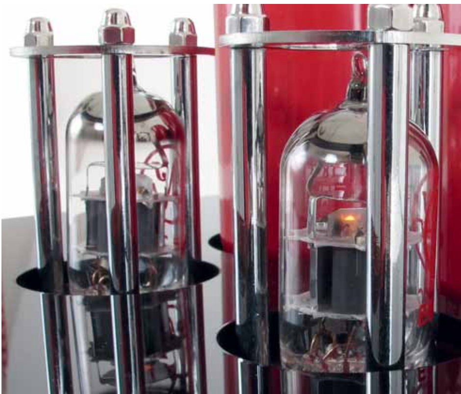
Le gabbiette in acciaio poste a protezione delle valvole.
