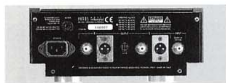
デジタル入力はRCA・1系統のみ。アナログ出力はRCAとXLR
