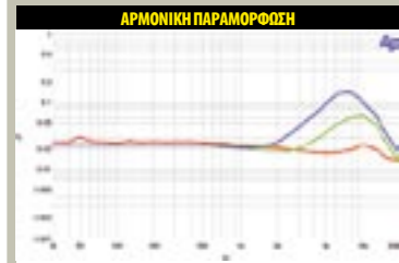
Καθόλου άσχημη συμπεριφορά και σε ό,τι αφορά τις παραμορφώσεις που παρέδωσε ο ενισχυτής. Ανεξαρτήτως ισχύος, κατά το μεγαλύτερο μέρος αυτές κινήθηκαν από 0,03% έως και 0,05%, με κάποιες εξάρσεις στην υψηλή περιοχή, που δεν ξεπέρασαν το 0,15%.
