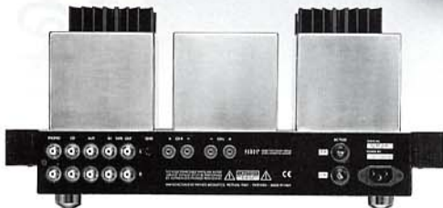
リアビュー。中央にパワー段用電源トランス、左右にパワー段のINPOL回路用チョークコイルを配置。プリ部用トイダルトランスは筐体内に収納されている。入力はライン3系統。
