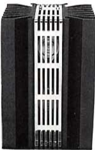
リアビュー。中央にパワー段用電源トランス、左右にパワー段のINPOL回路用チョークコイルを配置。プリ部用トイダルトランスは筐体内に収納されている。入力はライン3系統。
